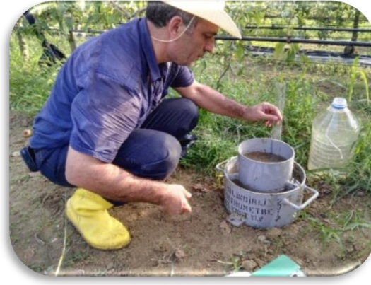
Şekil 3. Çift Silindirli İnfiltrasyon ile Su İnfiltrasyonunun Ölçülmesi
