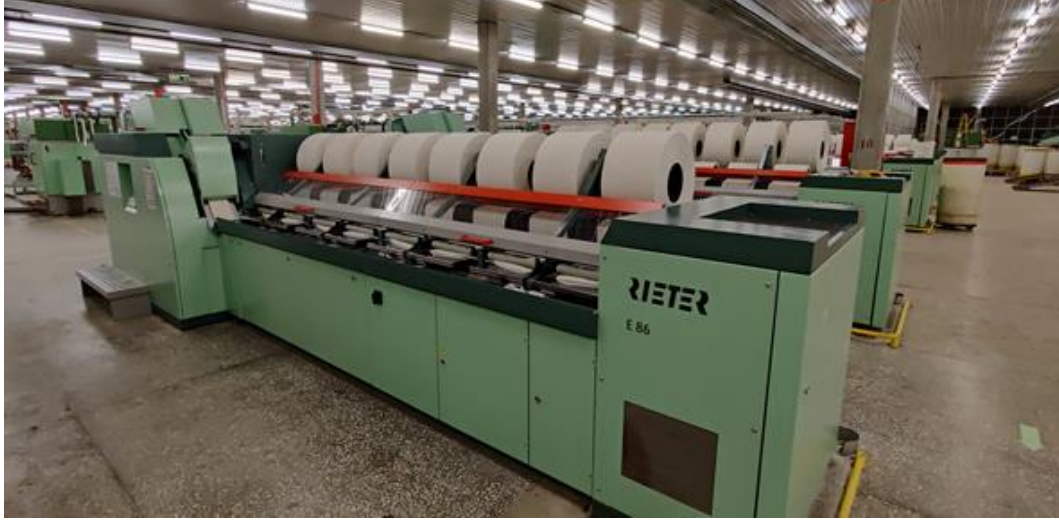
Şekil 16. Penye makinası (Penyöz E 86)
