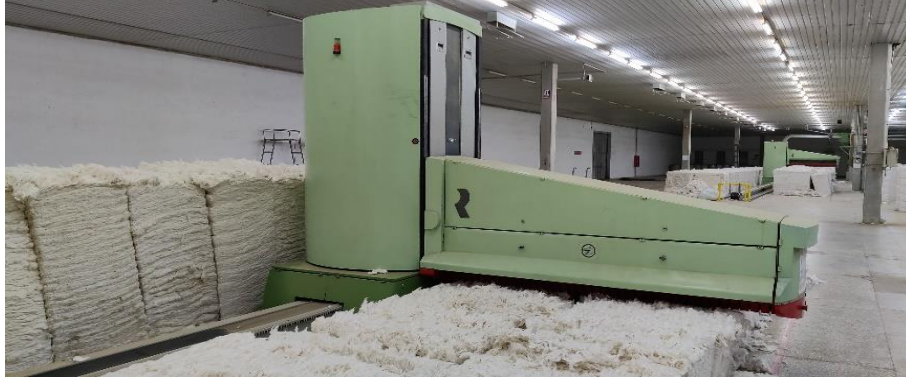
Şekil 2. UNIfloc (Balya Açıcı)
