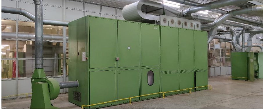
Şekil 4. UNImix (Çok Kamaralı Karıştırıcı)
