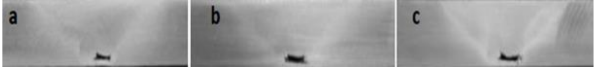
Şekil 4. 900 dev/dk devirde yapılan kaynakların dağlanmış yüzey görüntüleri, (a) 20 mm/dk, (b) 40 mm/dk, (c) 60 mm/dk (Çevik vd., 2012)
