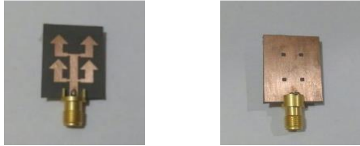
Şekil 17 - Önerilen anten ve DGS yapısı (Sandi vd., 2021: 3-4).
