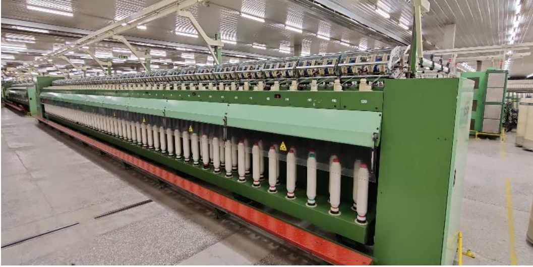
Şekil 18. Fitol Makinası (F 16)
