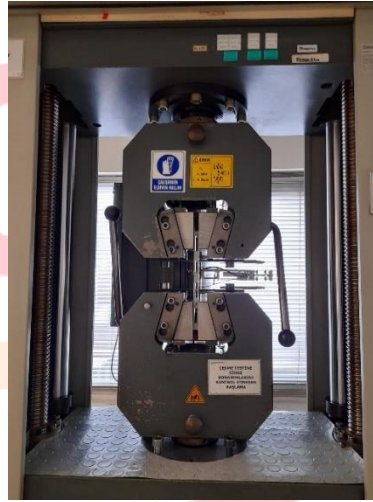
Şekil 7. Alternatif tasarımların prototiplendikten sonra çekme numunelerinin çıkarılması
