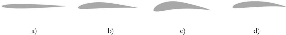
Şekil 1. Analiz edilen kanat yapıları; a) Naca 0006, b) E 387, c) Eppler 421, d) SG 6043
