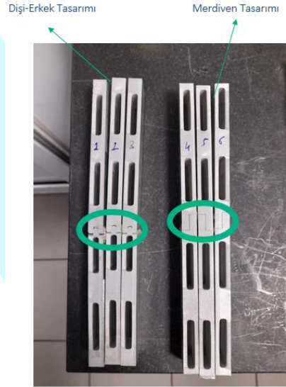
Şekil 7. Alternatif tasarımların prototiplendikten sonra çekme numunelerinin çıkarılması
