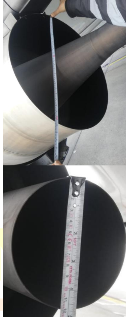
Şekil 4. (a) CFM56-7B'ye ait nozul ölçülerine ait boy ölçüleri (Boeing, 2019), (b) Aynı nozula ait bazı çap ölçümlerinin yapılması
