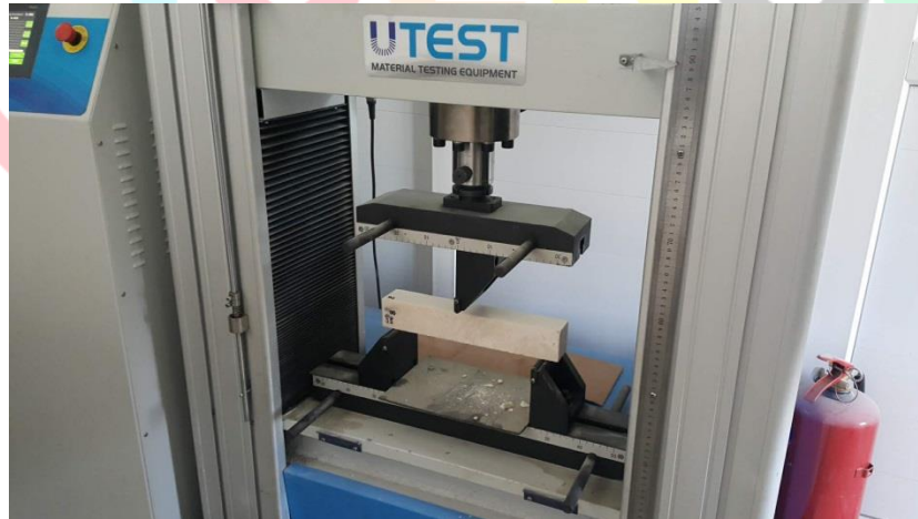
Şekil 6. Kayaçların 3NED değerlerinin belirlenmesi
